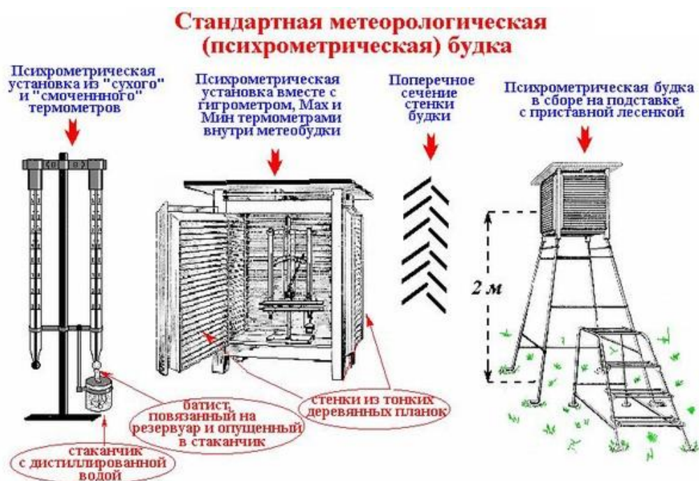
Рис. 3. Психрометрическая будка (общий вид)
