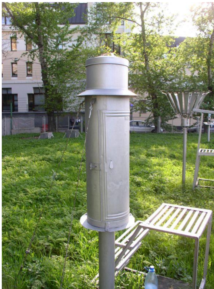
Рис. 16. Плувиограф (передний план), осадкомер Третьякова (задний план)
